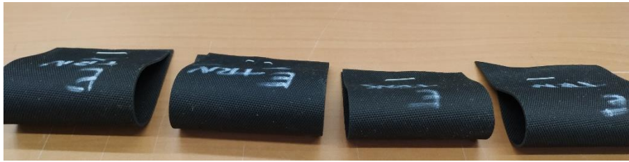
Figura 2. Probetas después del ensayo de flexión y haber recuperado temperatura ambiente, probetas de corte transversal.
