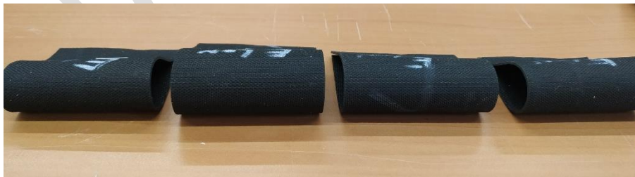
Figura 1. Probetas después del ensayo de flexión y haber recuperado temperatura ambiente, probetas de corte longitudinal.
