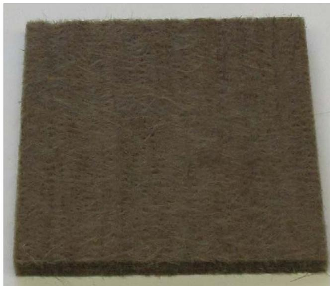
Figura 2. Riproduzione fotografica di uno dei tre provini 100x100x9 mm ricavati per taglio dal pannello tal quale 1200x600x9 mm del prodotto "NOBILIUM®THERMALPANEL – Fibra Minerale Naturale" di Figura 1 e successivamente testati.
