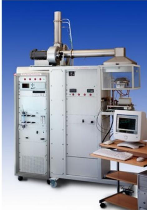
Figura 3. Cono calorimetro FTI (Rif. 2-e) utilizzato per le prove sperimentali.
